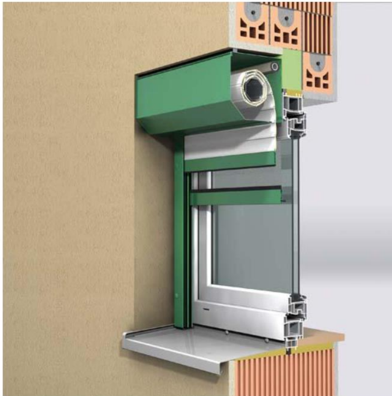
Slika 10-3: Primer zunanjega senčila in energetskega okna (vir: Tehrol)
